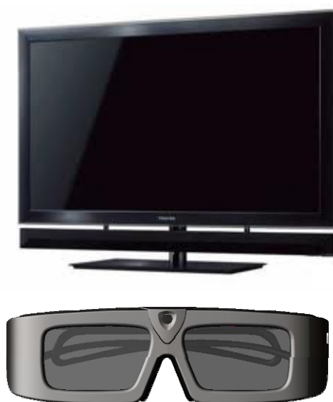
Figure 30 : principe de la vision stéréoscopique avec lunettes actives, on voit le capteur infrarouge au milieu des lunettes
