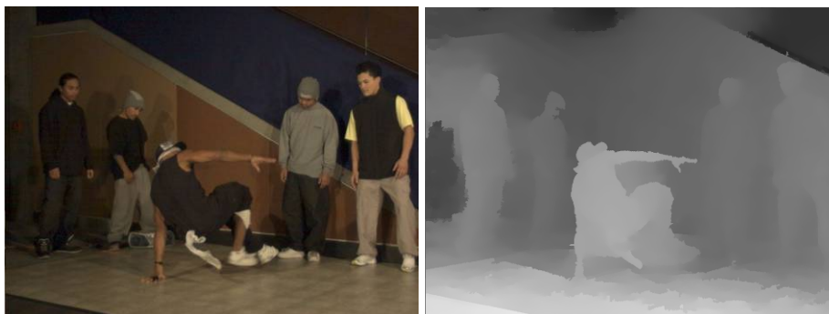
Figure 23 : représentation vidéo-plus-profondeur, exemple d'une vidéo et de la carte de profondeur correspondante
