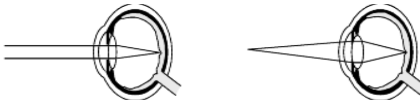
Figure 3 : accommodation pour un objet à l'infini (figure de gauche) et un objet proche (à droite)
