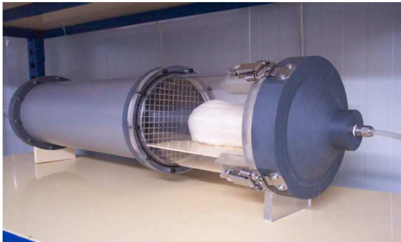
Figure 47 : Enceinte individuelle d'inhalation pour animal vigile, non contraint entrée cage / sortie cage
