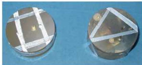
Photographie 2 : Echantillons préparés pour l'observation et l'analyse au MEB (rouleau et vrac de gauche à droite)
