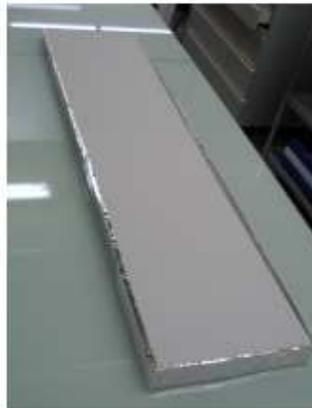
**Figure 2 :** Eprouvette de dalle de plafond en laine de verre avant introduction en chambre d'essai d'émission
