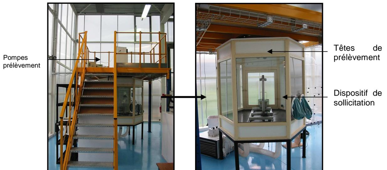
Figure 2.1 : chambre de simulation Aérotest
