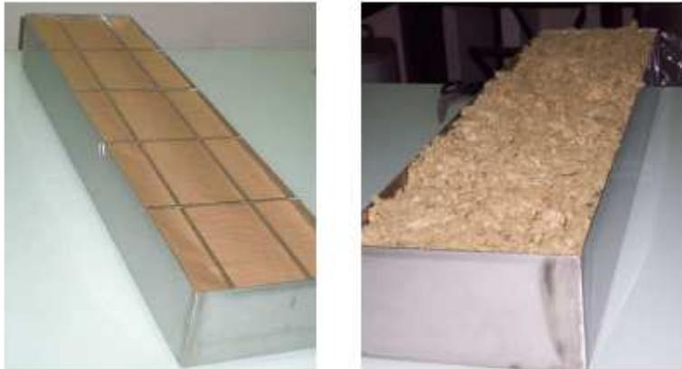
**Figure 1 :** Eprouvette de rouleau de laine de verre avec pare-vapeur (photo de gauche) et de flocons de laine de roche (photo de droite) en boîte de conditionnement, avant introduction en chambre d'essai d'émission
