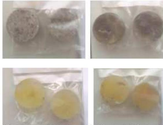
Photographie 1: 4 palettes d'échantillons de FMA de gauche à droite et de haut en bas : Flocage, Vrac, Dalle et Rouleau
